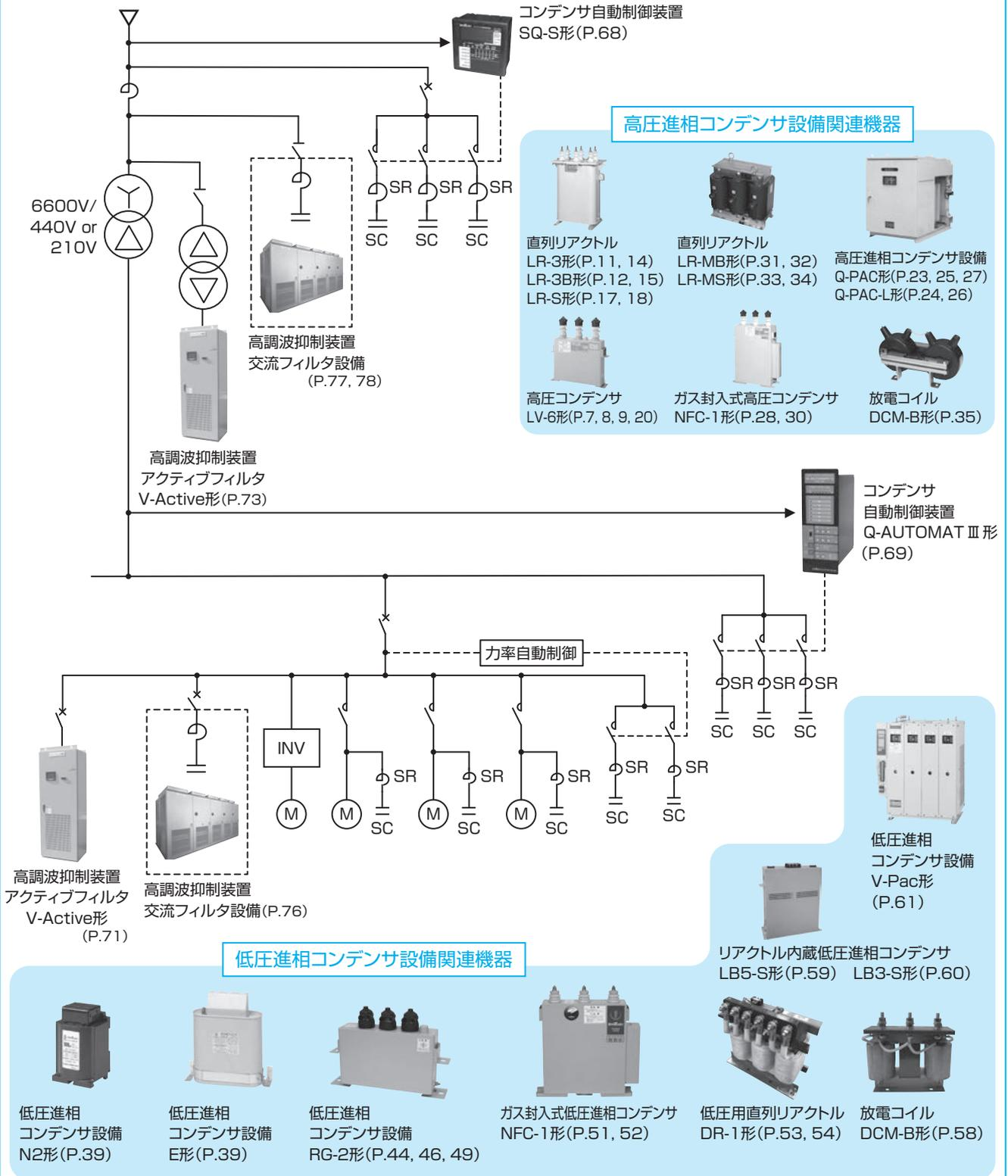
注)同一系統にインバータ制御された負荷がある場合、必ず低圧コンデンサ設備には直列リアクトル(L=6%)を設置願います。
