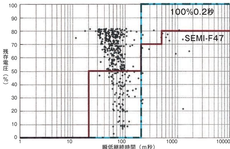
注1:電圧低下率(%)=100-残存電圧(%) 注2:SEMI-F47は半導体製造装置の瞬低耐量を規定する規格
